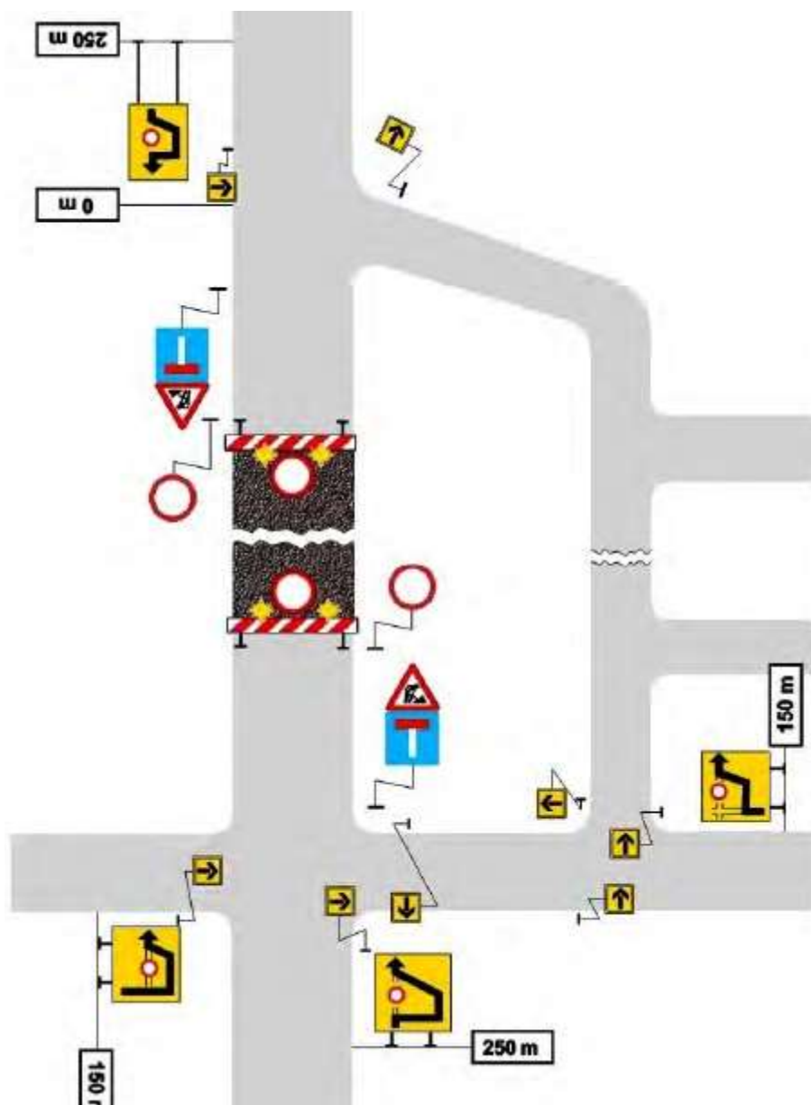
16. ábra – Az úttest teljes lezárása terelőút kijelölésével
