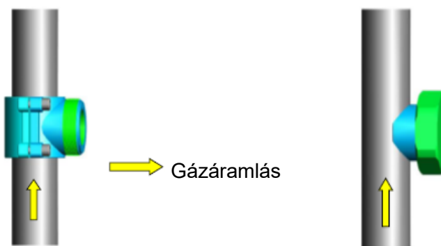
2. sz. ábra: csatlakozó szerelvények elhelyezése csővezetéseken
