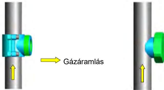
2. sz. ábra: csatlakozó szerelvények elhelyezése csővezetéseken
