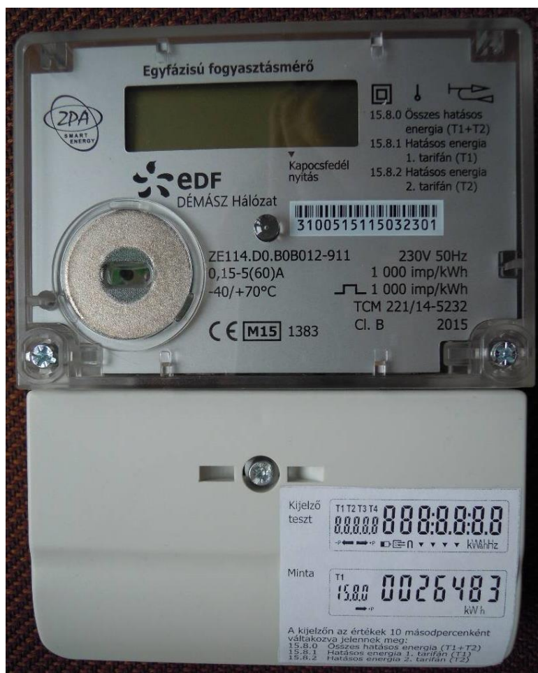
ZPA ZE114 mérő LCD kijelzője:
