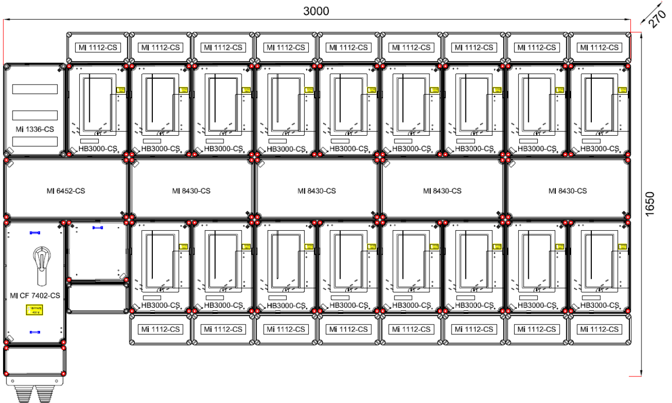
A tájékoztató jellegű rajz 16 fogyasztós, fogyasztónként 1 mérőhelyes kialakítást ábrázol közösségi méréssel és elosztással.
